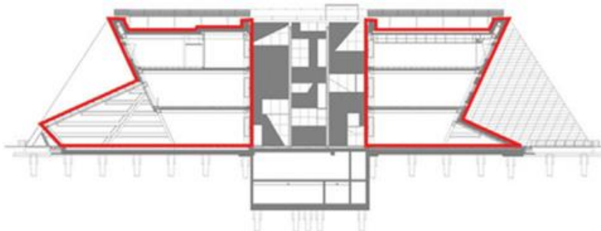
기밀면(Blower Door Test)
